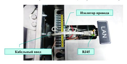
Подключить коннектор к разъему RJ45 и заправить кабель в изолятор.
