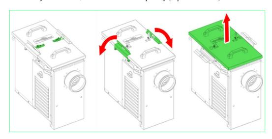
3. Снять крышку блок управления (БУ), отвернув четыре винта M3x10.
