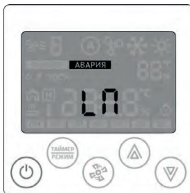
Снятие аварийной ситуации осуществляется «сбросом» питания всей установки (снять и подать напряжение питания).
