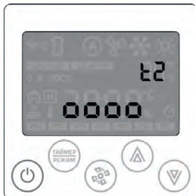
Переход к редактированию следующей задачи – нажать кнопку «Вентилятор». Стрелками «Вверх» или «Вниз» устанавливается номер следующей задачи для редактирования.
